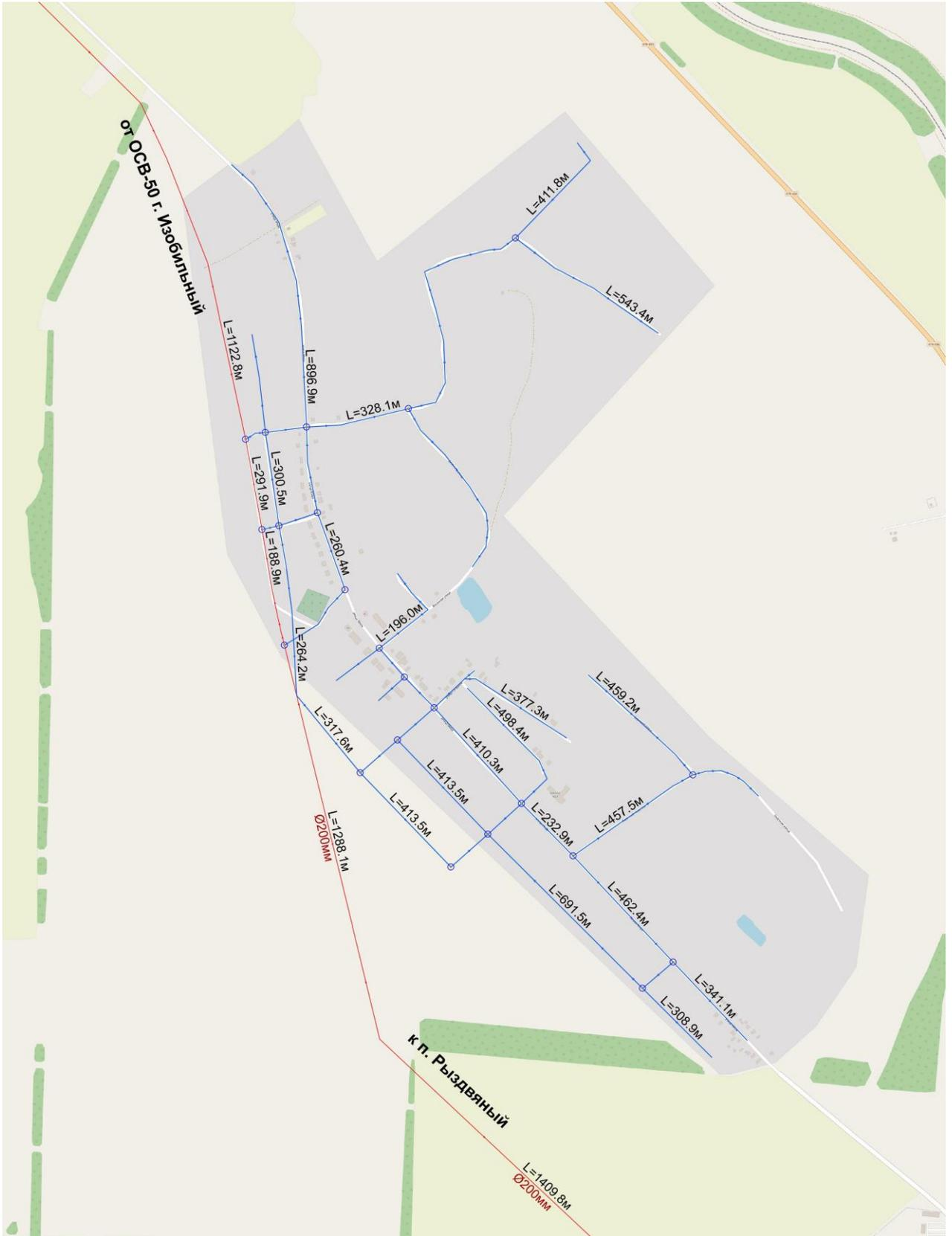
Рис. 1.4.9.18 – Схема водоснабжения х. Спорный
