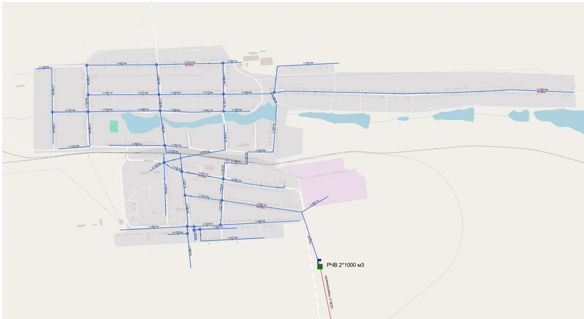
Рис. 1.4.9.4 – Схема водоснабжения п. Передовой
